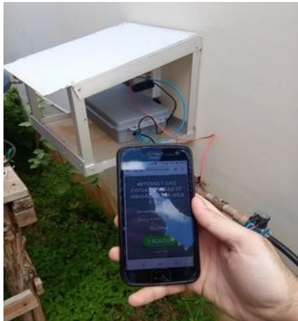
Figura 3 - Sistema de automação sem fio da horta utilizando ESP8266
