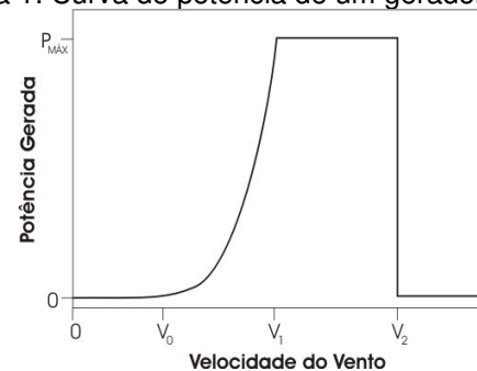
Figura 1: Curva de potência de um gerador eólico.
