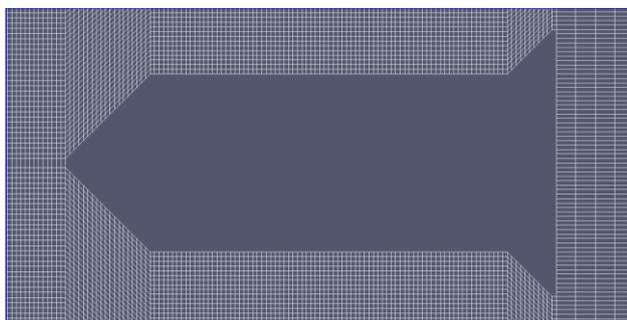
**Figura 1.** Esquema bidimensional de *mesh* para robô submarino.
