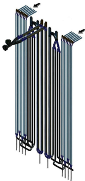
Figura 1. Disposição dos tubos em um modelo particular de serpentina de forno de pirólise.
