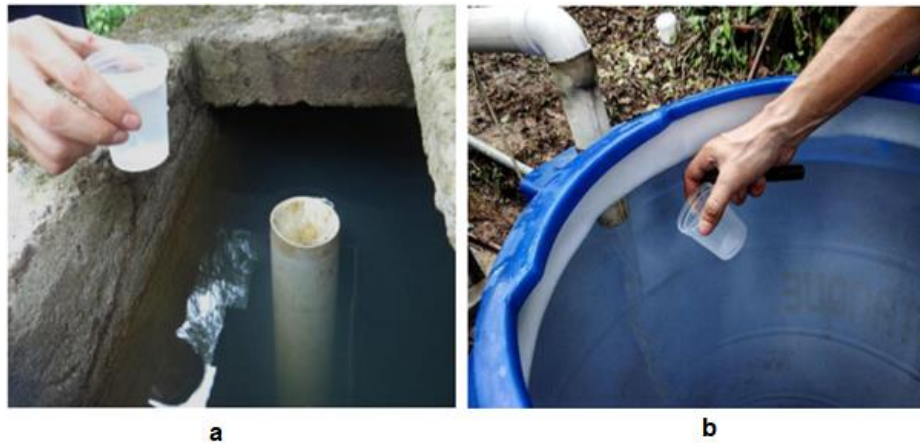
Figura 4: Coletas de amostra Pré-filtragem (a) e Pós filtragem(b). Fonte: Dos Autores
