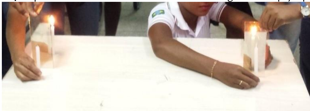
Figura 4 - Experimento en clase sobre la formación de imágenes en espejos planos.
